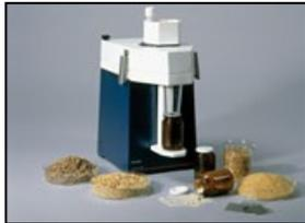
**Macinazione:** è stata realizzata mediante molino Cyclotec 1093 (International PBI) con vaglio da 500  $\mu\text{m}$  ed il macinato è stato conservato in un contenitore chiuso a temperatura ambiente fino al completamento delle analisi.
